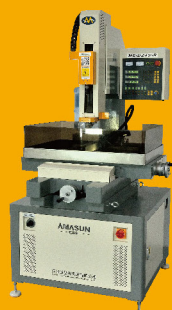
B系列 精密机型 MS-DZ435B MS-DZ640B (电极范围0.2-3mm)
